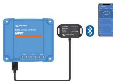
Připojení aplikace VictronConnect přes Bluetooth pomocí VE.Direct Bluetooth Smart Dongle.
